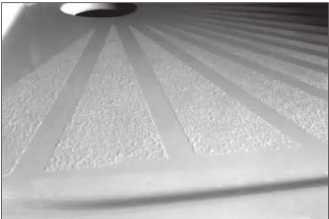
Abb. 2 Nahaufnahme Anti-Rutsch Beschichtung, aufgebracht an einer Duschwanne
